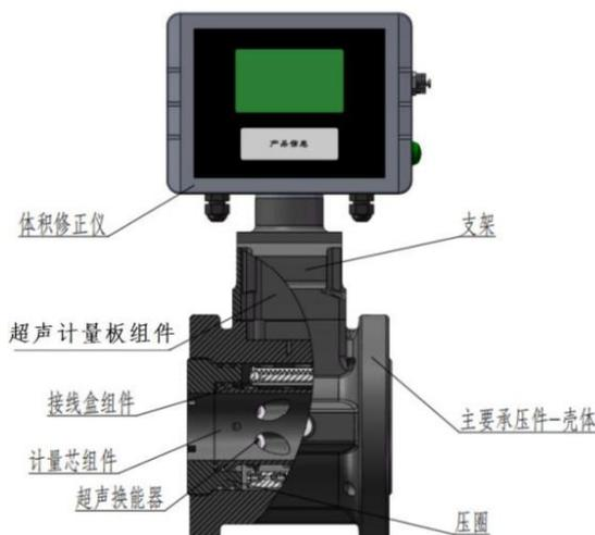
图4 DN50 结构示意图
